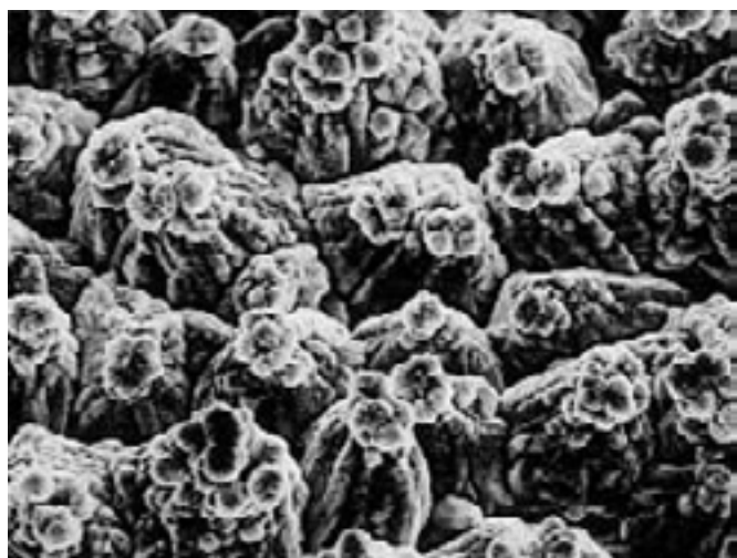
Внешний вид матовой поверхности электролитической фольги
