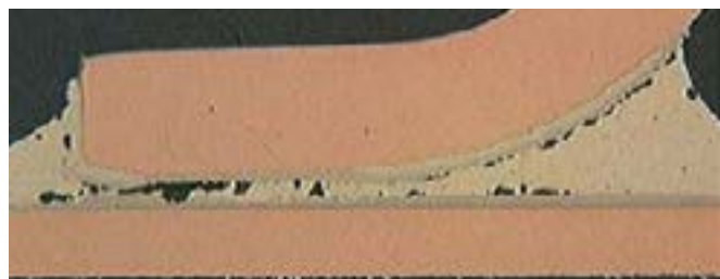
Рис. 3. Поперечный срез паяного соединения, содержащего диффузионные поры
