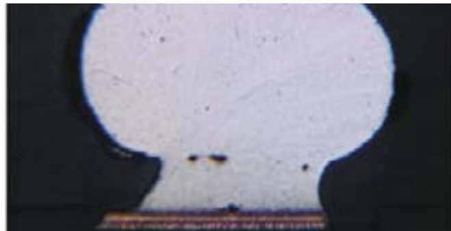
Рис. 5. «Холодная» пайка, возникшая при монтаже бессвинцового BGA-компонента на оловянно-свинцовую пасту
