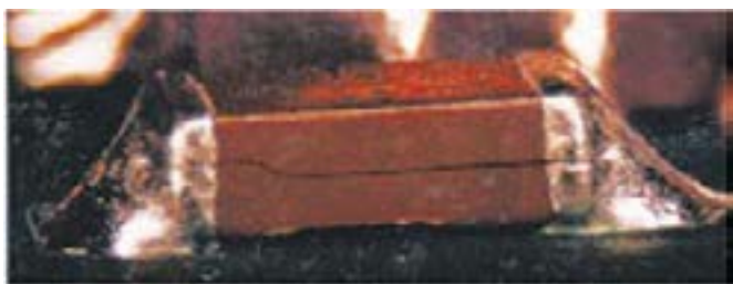
Рис.2. Расслоение чип-конденсатора при превышении температуры пайки
