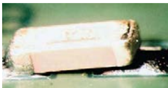
Рис. 4. Чип-конденсатор с эффектом «надгробного камня»
